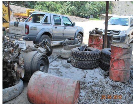
Gambar 3.2 Sistem Saliran Dan Perangkap Minyak Tidak Disediakan Di Kawasan Bengkel
