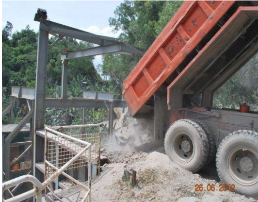
Gambar 3.15 Batu Dimasukkan Ke Dalam Crusher Plant Untuk Dihancurkan
